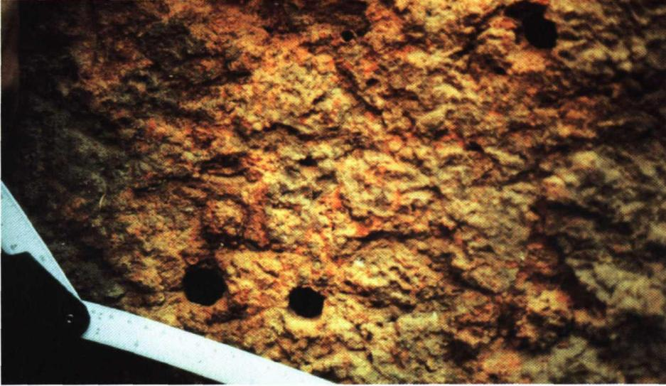
*Photo 1.1 : Canalicules repérées dans une couche d'argile sableuse lors de l'ouverture d'une tranchée de reconnaissance.*
