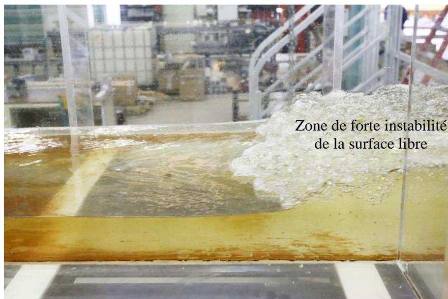
Figure 47. Exemple de ressaut hydraulique dans un canal de laboratoire.
