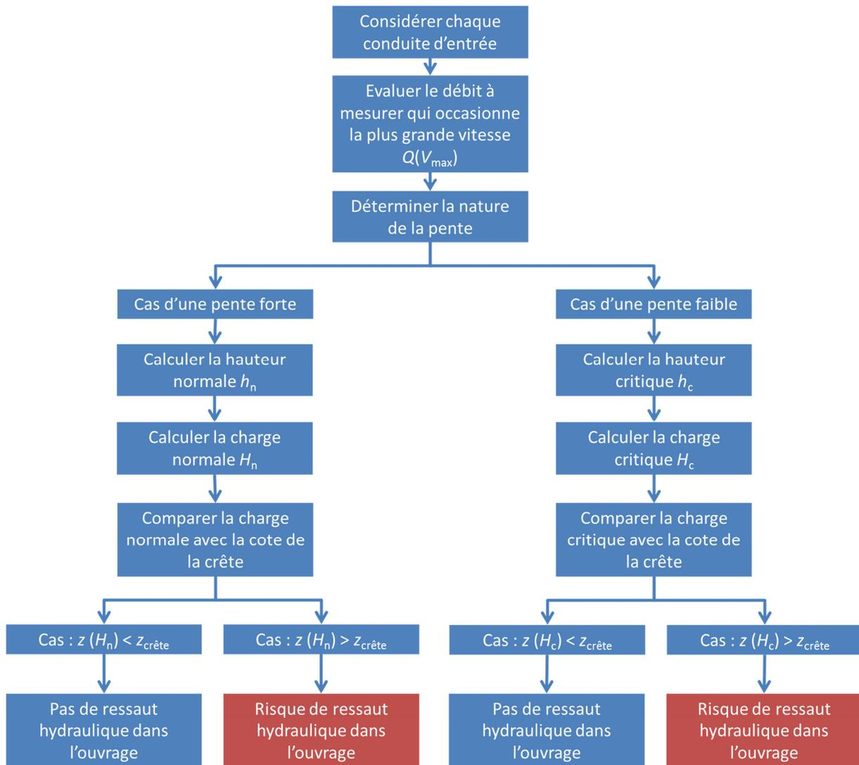
Figure 48. Organigramme permettant de diagnostiquer le risque de ressaut hydraulique dans le déversoir d'orage.
