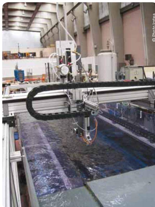
Mesure de vitesse au tube de pitot dans le lit majeur d'un canal composé (LMFA, INSA de Lyon)
