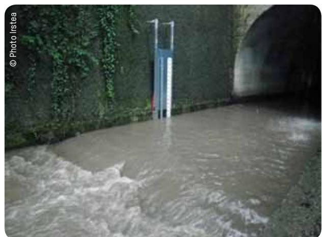
Station hydrométrique contrôlée par ouvrage à double sensibilité installée sur le bassin versant de l'Yzeron
