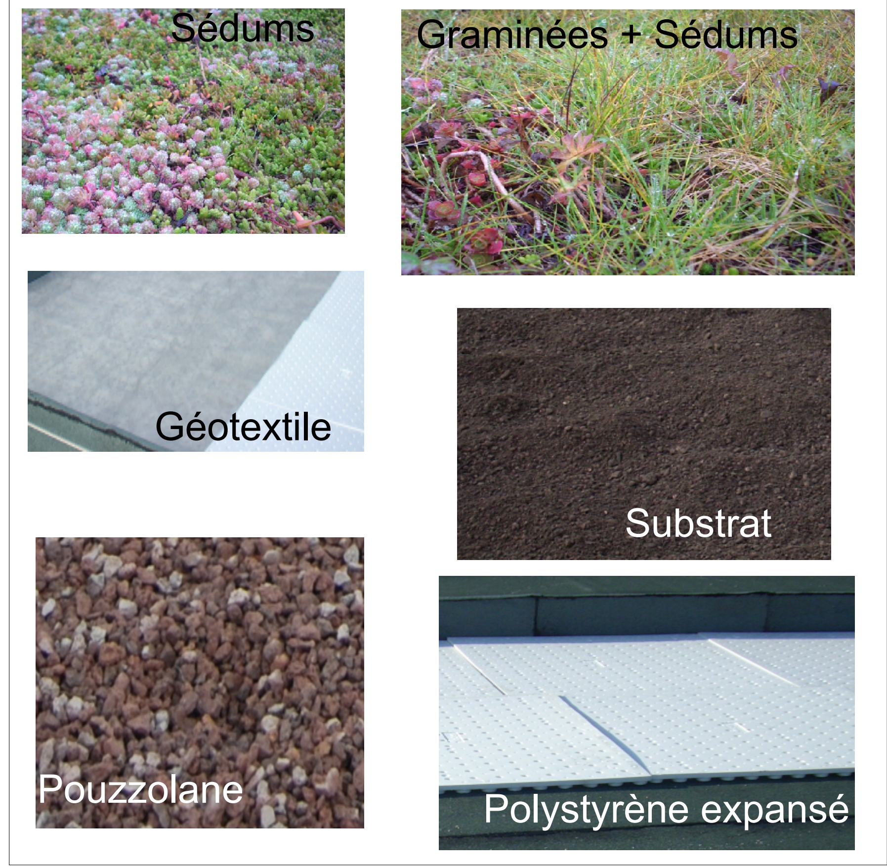
Figure 3 : Les composants des toitures végétalisées du CETE IF à Trappes.
